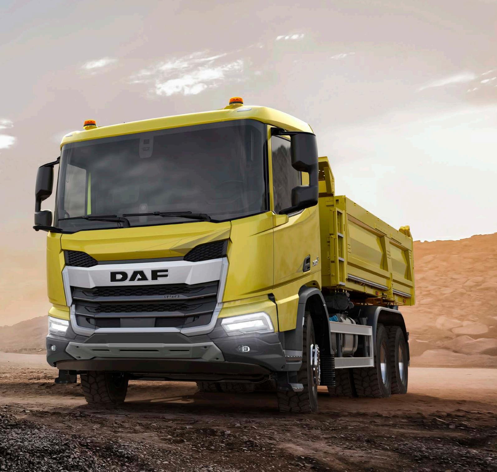
v případě nehody. Robustní konstrukce kabiny poskytuje ochranu ze všech stran a zahrnuje deformační zóny v motorové přepážce i v zadní stěně (chrání proti uvolněnému nákladu). Systém kontrolovaného posunutí kabiny (ProCaDis) brání jejímu oddělení od podvozku a maximalizuje prostor pro přežití posádky. Systém řízení deformace sloupku řízení (CoDeS) zmírňuje následky zadního nárazu návěsu na řidičův hrudník, části přístrojové desky pohlcující nárazy pak chrání jeho kolena.
