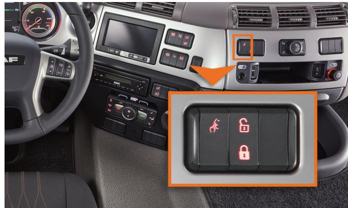
Druhou částí řešení je tichá funkce v motorovém software aktivovaná spínačem tichého provozu na palubní desce. Při aktivaci motorový software omezí maximální otáčky a točivý moment motoru, což má za následek nižší hladinu hluku. Tiché řešení společnosti DAF je v souladu s její odpovědností konstruovat ekologická a trvale udržitelná vozidla.
